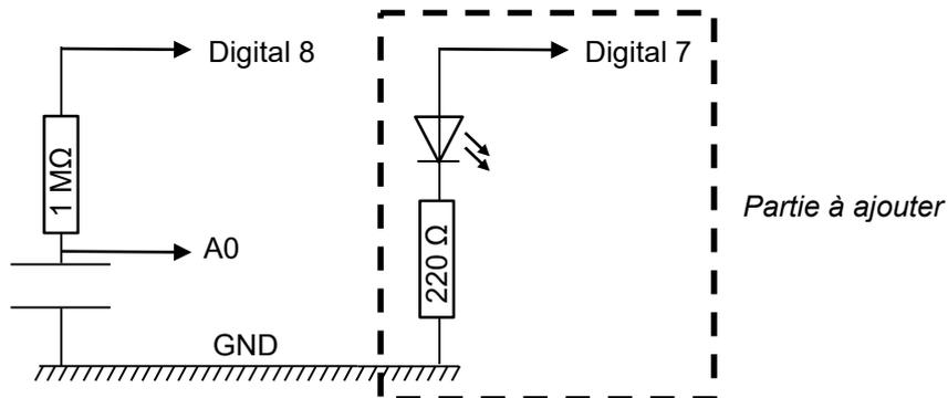
3.2. Calculer la valeur de la capacité de seuil  $C_{seuil}$  déclenchant la commande de la DEL.
