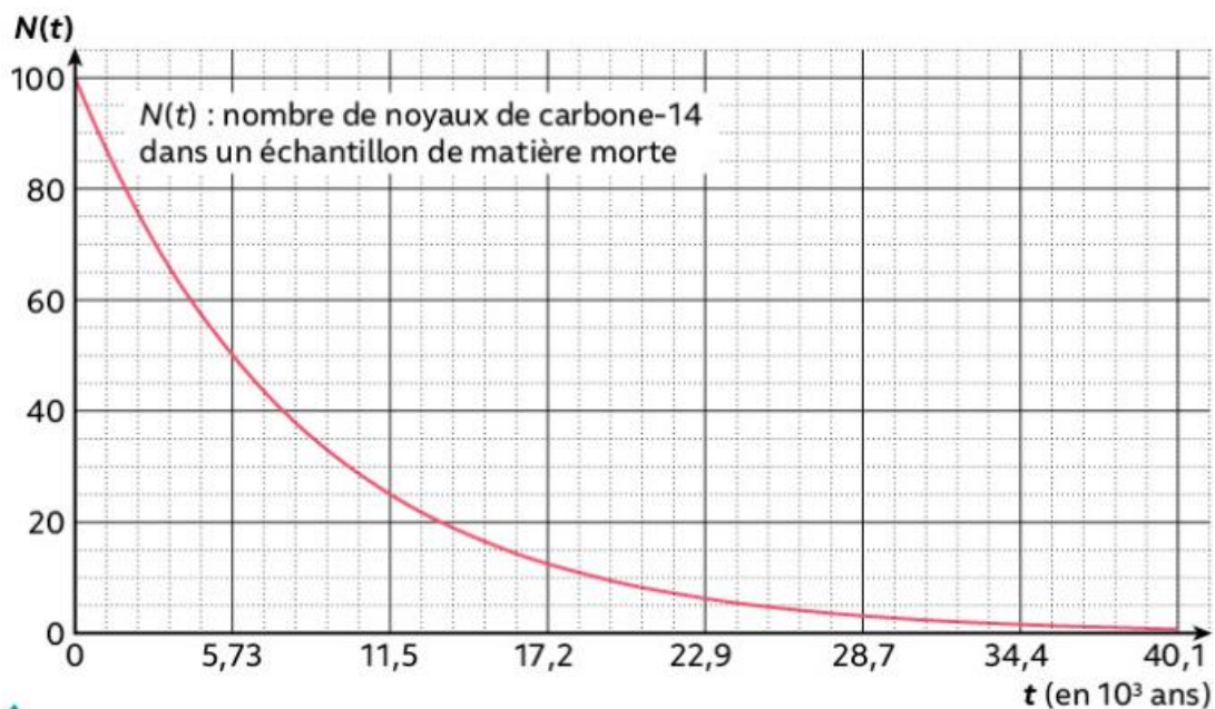
Figure B – Courbe de décroissance radioactive du carbone ^{14}\text{C}
