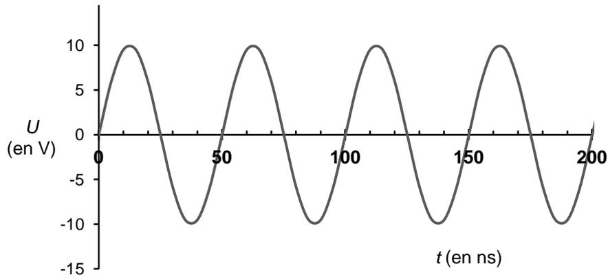
L'émetteur génère des ondes ultrasonores de même fréquence que celle de la tension qui l'alimente.
