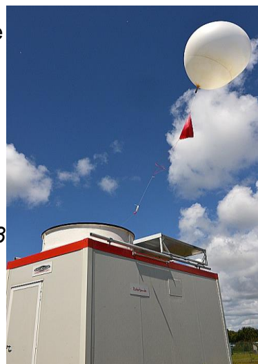
Figure 1 : lâcher de ballon automatique © Météo-France, Pascal Taburet
