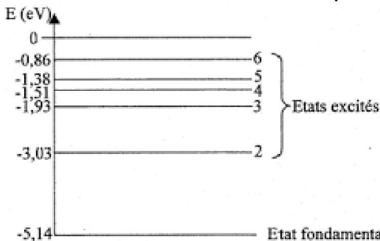
Figure 4 : Diagramme des niveaux d'énergie du sodium
