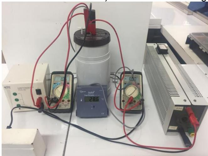
La résistance est en série avec un générateur de tension, de force électromotrice  $E$ , ainsi qu'un rhéostat de résistance variable  $R' = 33 \Omega$ .
