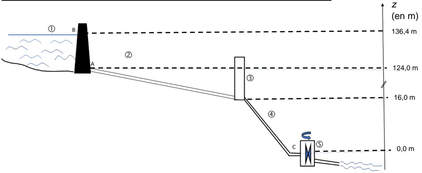
La retenue, où est stockée l'eau à turbiner, est le barrage de Record (1), hameau situé à quelques kilomètres en amont. L'eau est acheminée par une conduite d'amenée (2), et passe brièvement dans une chambre d'équilibre de forme cylindrique (3) et est envoyée sur deux turbines identiques (5) par une conduite forcée (4).
