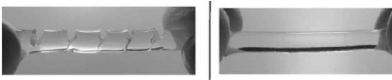
Figure 1: à gauche, un hydrogel coupé et à droite ce même hydrogel autocicatrisé
