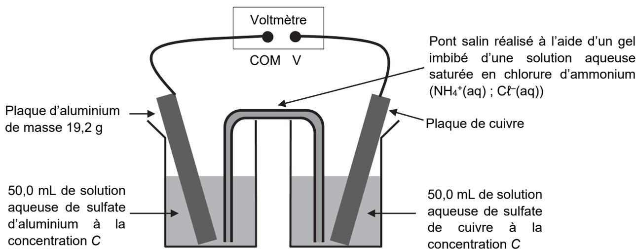
Figure 1. Schéma de la constitution de la pile
