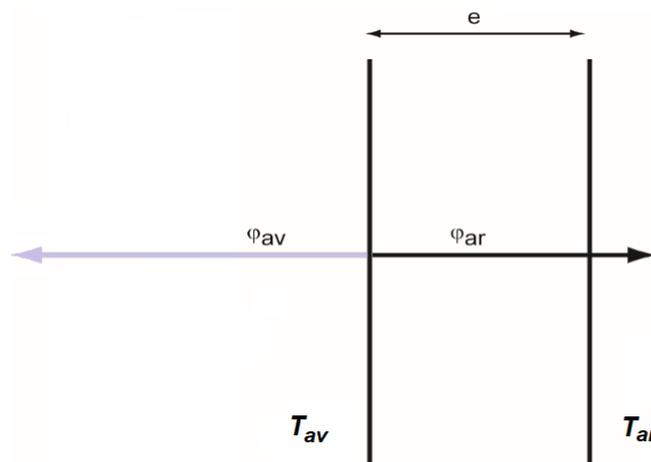
**figure 6** – Flux thermiques au niveau du bouclier thermique
