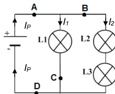
Indiquer, parmi les positions **A**, **B**, **C** ou **D** où pourrait être placé l'interrupteur pour répondre à ce cahier des charges.
