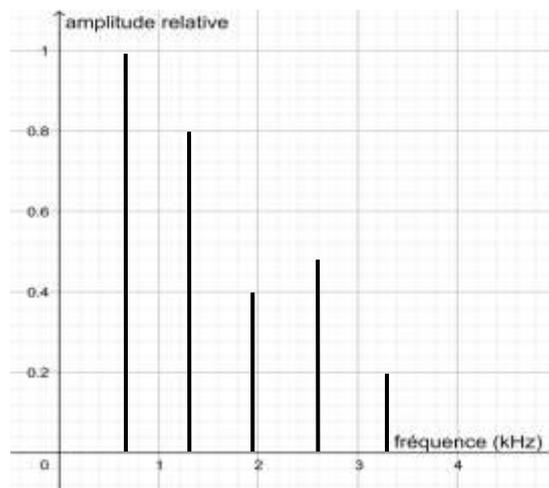
Figure 1. Spectre correspondant au mi<sub>4</sub> joué par la guitare
