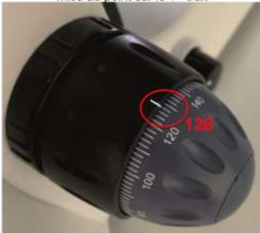
Photo du réglage de la vis micrométrique lors de la mise au point sur le 1 er trait
