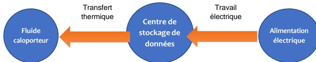
Le centre de stockage de données reçoit de l'électricité qu'il utilise pour faire fonctionner les composants informatiques. Une partie de l'énergie est dissipée sous forme de chaleur : énergie thermique. Celle-ci est transférée au fluide caloporteur.
