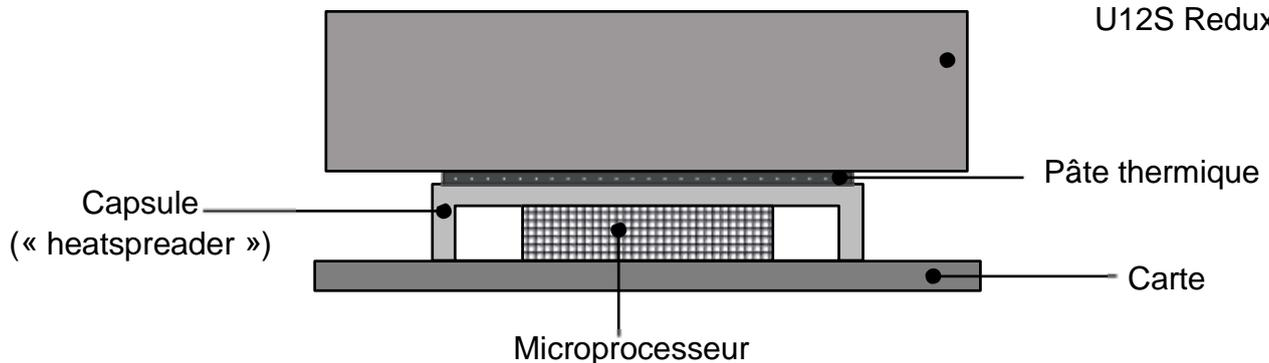
Figure1. Contact thermique entre un microprocesseur Intel core i5 11400F et son dissipateur thermique Noctua NH-U12S Redux.
