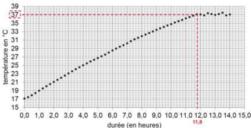
$$P = \frac{1,00 \times 10^3 \times 795 \times 4,18 \times 10^3 \times (37 - 17)}{11,8 \times 60 \times 60}$$
