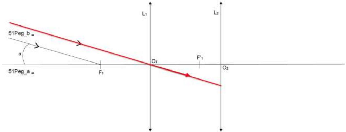
Le rayon lumineux 3 issu de **51Peg\_b<sub>∞</sub>** passant par  $F_1$  est dévié parallèlement à l'axe optique.
