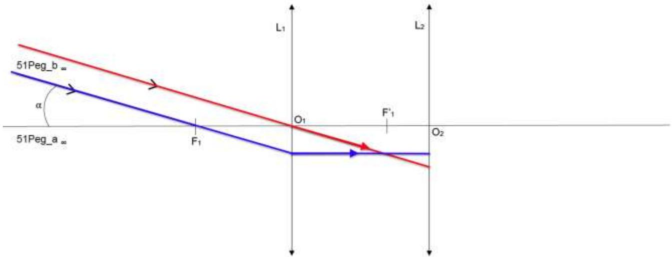
Position de **B<sub>1</sub>** image intermédiaire de **51Peg\_b<sub>∞</sub>** : intersection des deux rayons.
