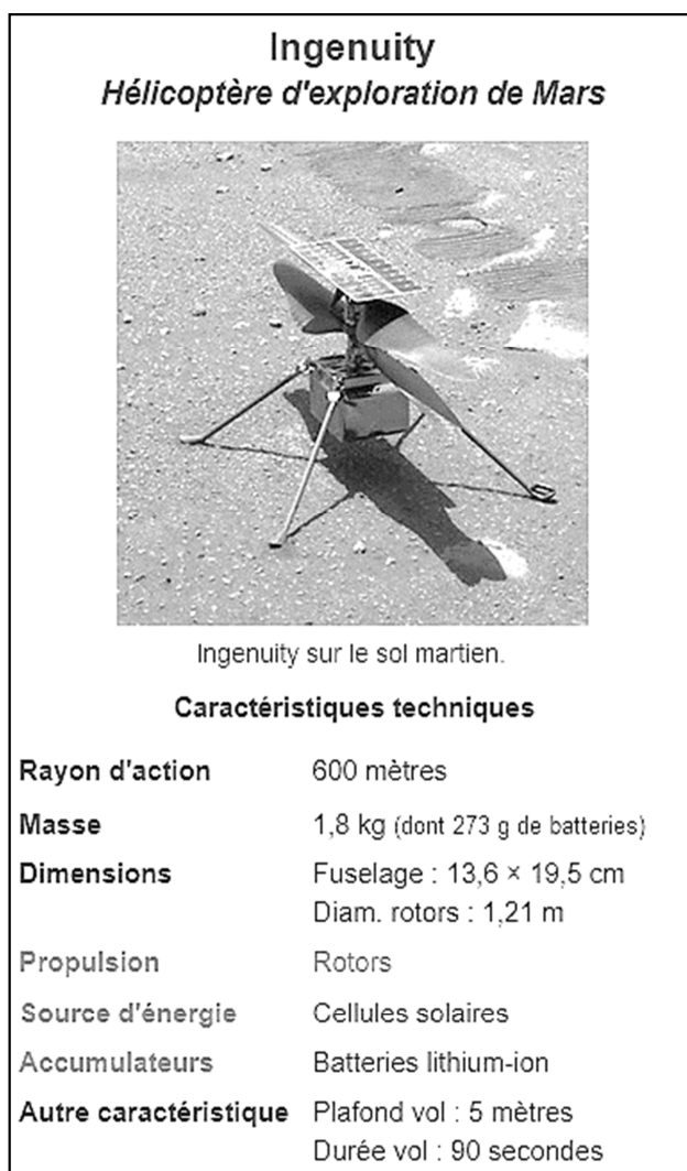
Figure 1 : Caractéristiques techniques d'Ingenuity
