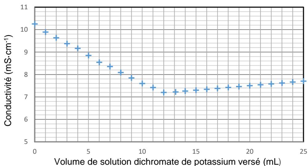
**Figure 2. Courbe de titrage conductimétrique de l'eau analysée**
