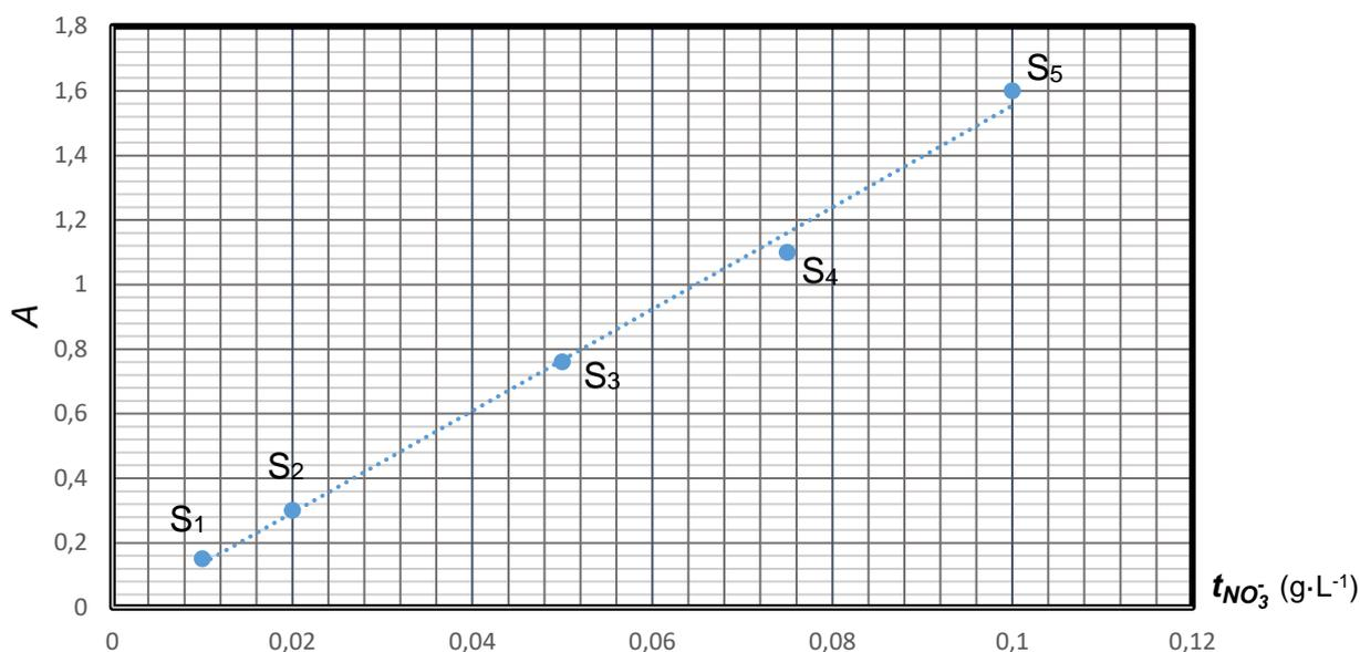
Figure 1. Courbe d'étalonnage des ions nitrate,  $\text{NO}_3^-$
