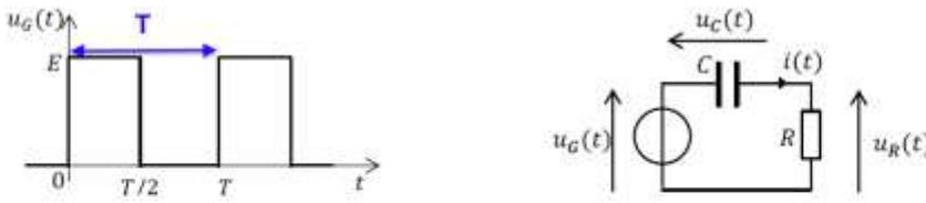
Figure 1. Signal d'entrée  $u_G(t)$  et schéma électrique du circuit
