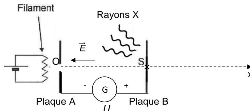
Figure 1. Schéma du tube à rayons X.
