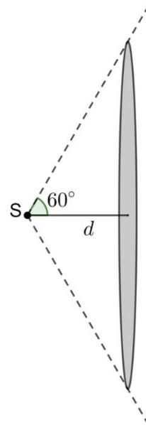
7. Déterminer la valeur de la surface du disque situé à une distance  $d = 1$  m de la source S.
