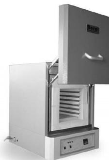
Lors de leur fabrication, certaines pièces métalliques peuvent présenter des faiblesses dues à un refroidissement inégal après la coulée ou lors du fraisage, du tournage ou du rabotage. Pour réduire les contraintes dans la pièce, on procède à un recuit de détente.
