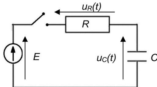
Figure 2. Circuit RC modélisant le fonctionnement du microphone.
