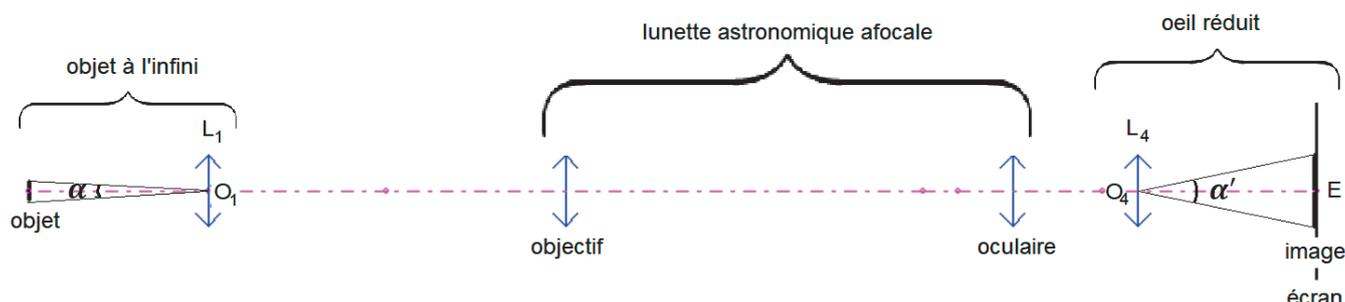
L'« objet à l'infini » est modélisé au moyen d'un objet et d'une lentille convergente  $L_1$  positionnée de telle sorte que l'image qu'elle forme de l'objet soit située à l'infini. C'est cet « objet à l'infini » qui est ensuite observé par la lunette astronomique.
