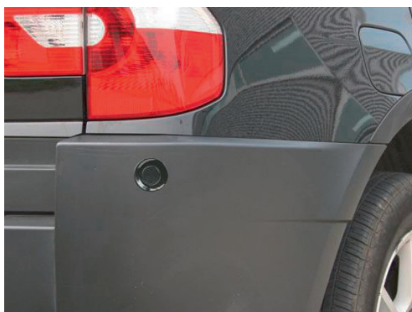
Radars de recul sur une automobile
