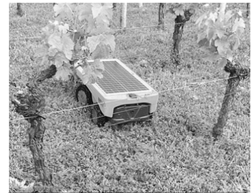
figure 1 : robot VITIROVER en situation dans la vigne
