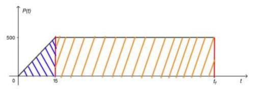
Évolution de la puissance en fonction du temps au cours du chauffage avec P(t) en W et t en s
