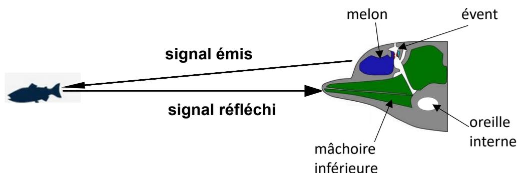
Le signal sonore est émis par les muscles de l'évent, puis amplifié par le melon. Il se propage dans l'eau et peut être réfléchi par un obstacle tel qu'un banc de poissons. La mâchoire inférieure du dauphin reçoit le signal réfléchi et le transfère à l'oreille interne.
