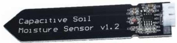
**Figure 1** : Photographie libre de droit d'un capteur d'humidité
