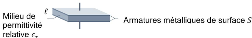
**Figure 2** : Représentation schématique d'un condensateur plan
