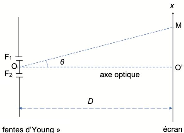
Figure 6. Mise en évidence de l'angle  $\theta$  dans le triangle O'OM
