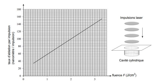
On admettra, comme le montre les schémas ci-dessous, que la profondeur totale p de la cavité gravée est proportionnelle au nombre d'impulsions reçues et donc à la durée  $\Delta t$  de la gravure.
