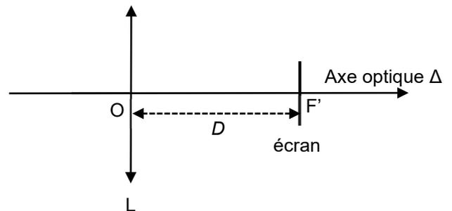
Figure 1. Schéma simplifié du modèle de l'œil
