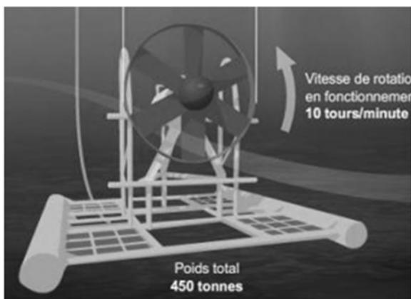
Cette hydrolienne, photographiée ci-dessus et schématisée ci-contre immergée, est constituée d'une **turbine sous-marine** qui permet de transformer l'**énergie cinétique des courants marins** liés au phénomène de la marée en énergie électrique grâce à un alternateur.
