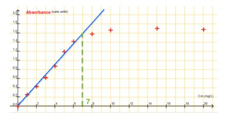
L'absorbance est proportionnelle à la concentration pour des valeurs de Cm<7,0 mgL<sup>-1</sup>. Au-delà, ce n'est plus proportionnel. Cette représentation est en accord avec la recommandation du fabricant.
