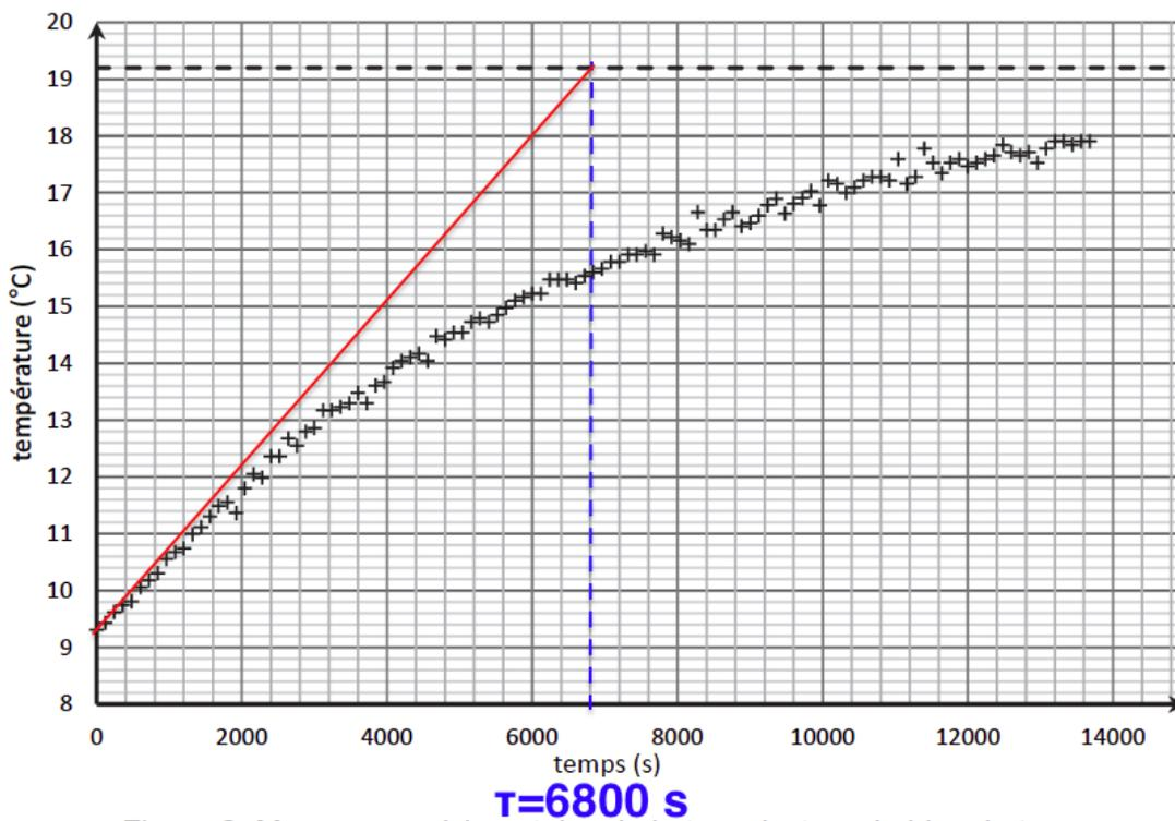
Figure 2. Mesures expérimentales de la température du bloc de tomme
