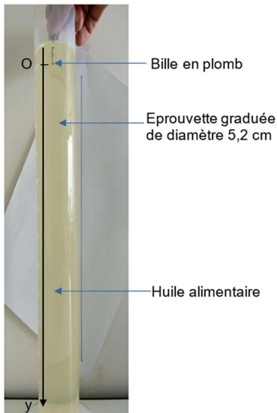
Le pointage des positions successives de la bille permet de tracer l'évolution de sa vitesse en fonction du temps :
