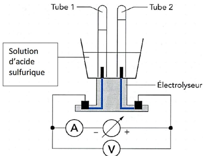
Dans cette expérience, le gaz produit à chaque électrode est récupéré dans un tube à essais.
