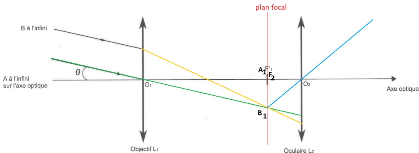
$A_1B_1$  étant sur le plan focal, il donnera une image à l'infini, tous les rayons issus de  $B_1$ , passant par la lentille  $L_2$  seront parallèles.
