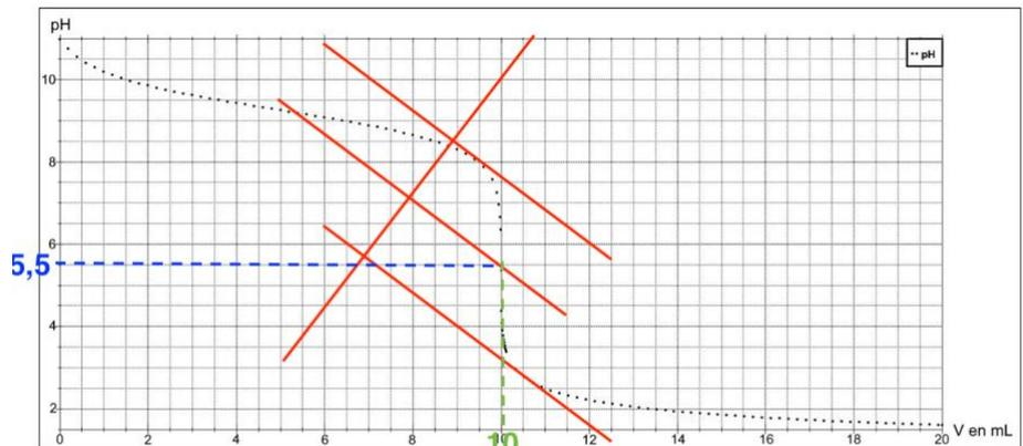
Figure 1 : courbe simulée du titrage de 20,0 mL de la solution aqueuse d'ammoniac par l'acide chlorhydrique de concentration 0,100 mol·L<sup>-1</sup>.
