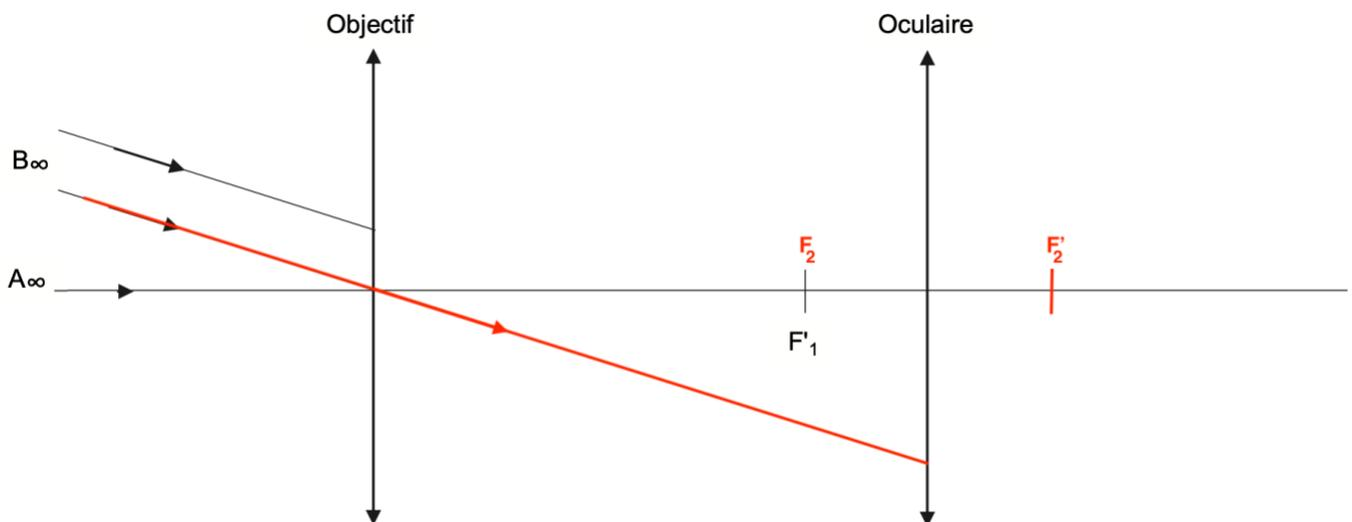
Position de  $B_1$  image intermédiaire de B : Comme l'objet  $A_\infty B_\infty$  est à l'infini, son image  $A_1 B_1$  est dans le plan focal image de l'objectif  $L_1$ .
