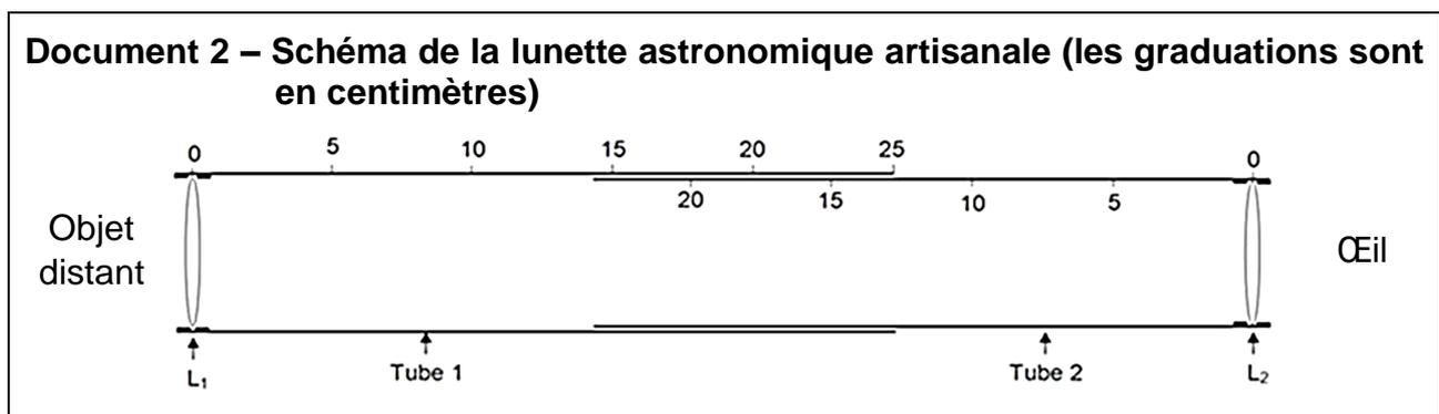
Dans la suite, on étudie ce dispositif afin d'identifier comment positionner les lentilles pour assembler une lunette afocale, puis de caractériser le grossissement de la lunette obtenue.
