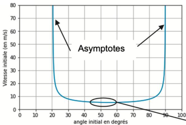
Figure 2-a. Vitesse initiale à donner au ballon à une distance  $L = 2 \text{ m}$  pour qu'il atteigne le centre C de l'arceau en fonction de l'angle initial
