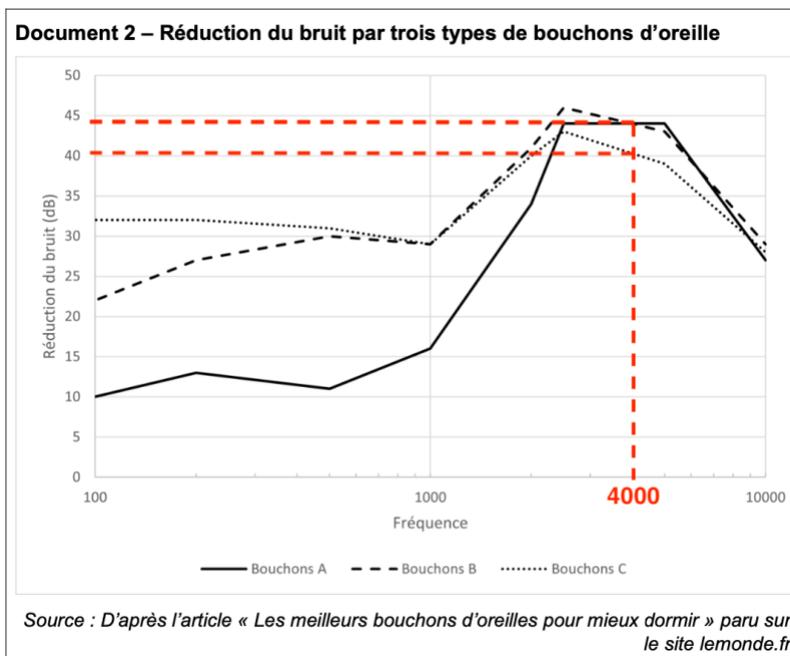
Les bouchons B et C réduisent de manière significative le son des échanges conversationnels (bande de fréquence de 80 Hz à 1 500 Hz).
