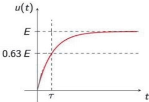
La tension électrique aux bornes d'un condensateur lors de sa charge s'exprime selon la relation :
