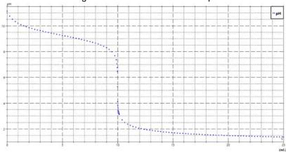
Titrage de 10,0 mL de solution d'ammoniaque de concentration 0,10 mol·L<sup>-1</sup> par une solution d'acide chlorhydrique de concentration 0,10 mol·L<sup>-1</sup>.
