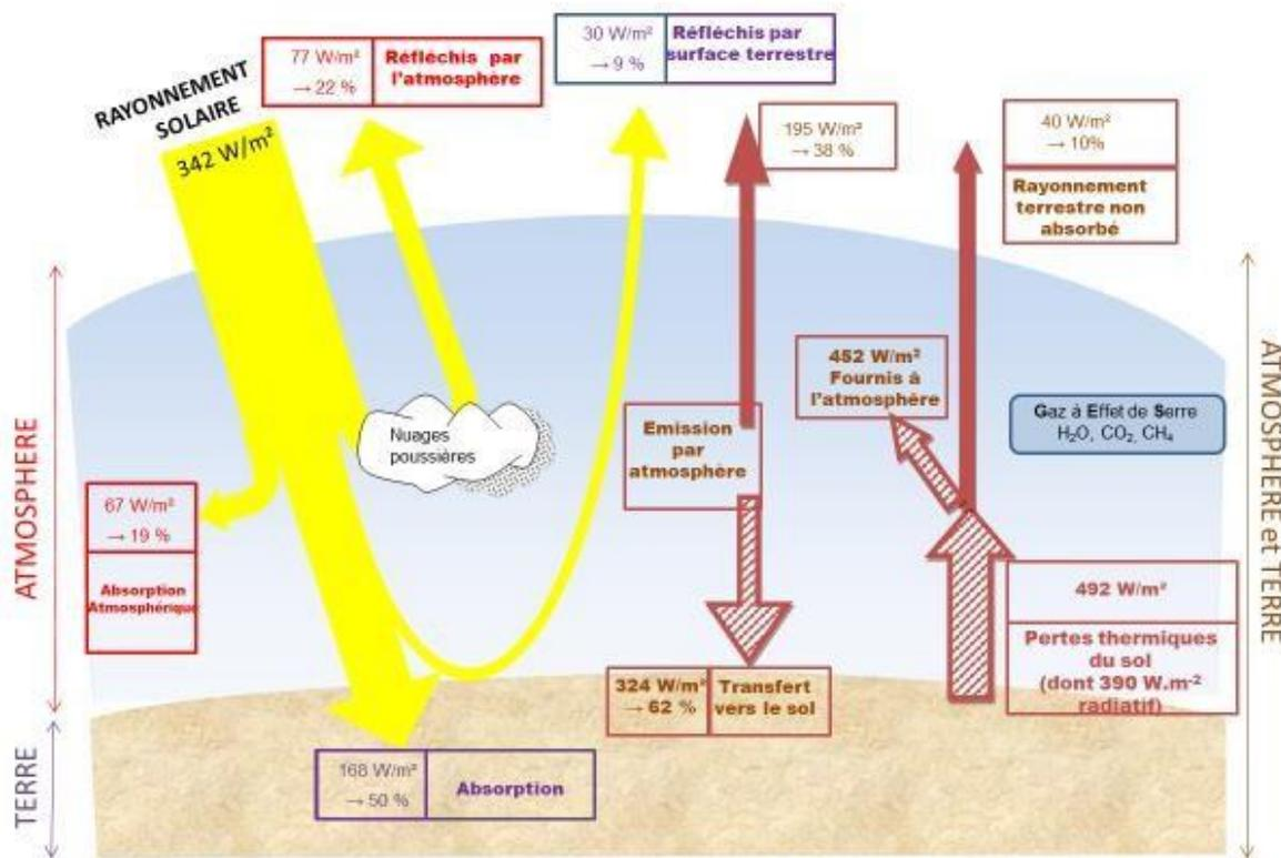
Le schéma précédent présente les flux énergétiques émis, diffusés et réfléchis par les différentes parties de l'atmosphère. L'albédo terrestre moyen est de 30 %.
