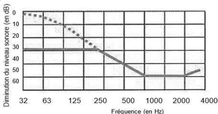
Pointillés : bouchons d'oreilles mal insérés
