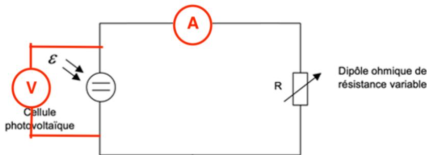
Le dipôle ohmique mis à disposition permet de régler des valeurs de résistance allant de 0 à 10 kΩ.
