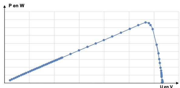
Le rendement  $\eta$  d'un panneau photovoltaïque peut être défini par la relation :  $\eta = \frac{P_{\text{élec max}}}{P_{\text{lum}}}$
