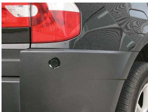
Radars de recul sur une automobile
